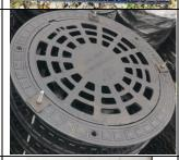
Дождеприемник круглый ВЧШГ ДУ(D400) плавающий с потайным шарниром, с 3-мя замками, с рез. прокл. «ласточкин хвост»
